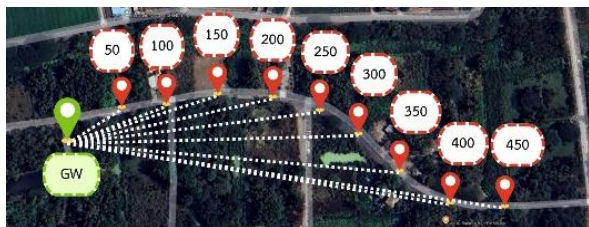
รูปที่ 4 ตำแหน่งการติดตั้ง End Device และ Gateway ในการทดสอบ
